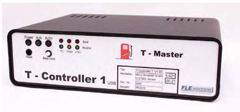
Abb. A2 Der T-Controller stellt die Verbindung zur Tankanlage und zu den weiteren Geräten an der Kasse her.
